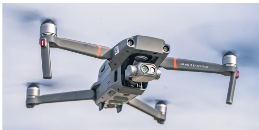
תמונה 7. רחפן עם מצלמה רגילה ותרמית מובנית (מתוך אתר DJI)
