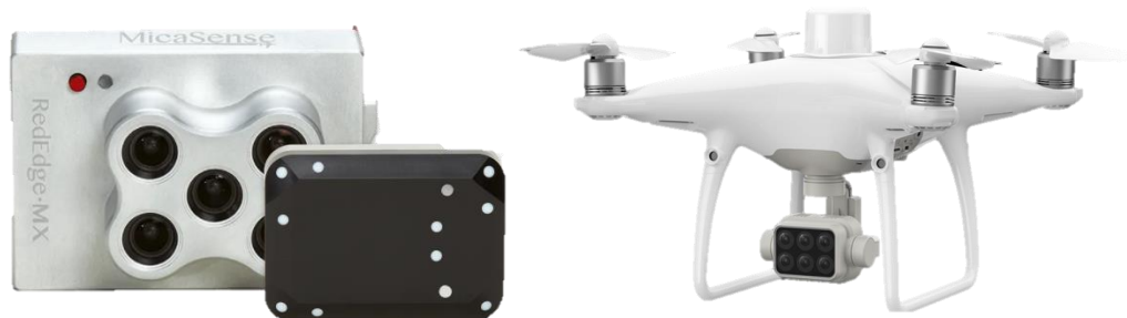
תמונה 5. רחפן עם מצלמה מולטי-ספקטראלית מובנית ומצלמה מולטי-ספקטראלית וחיישן אור (מתוך אתר DJI ואתר micasense)
